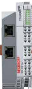
EtherCAT коптеры с интегрированной системой ввода-вывода
