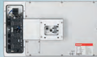
Open wiring space
